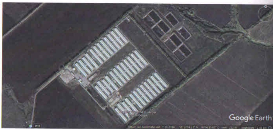
Рис. 2. Спутниковый снимок территории свиноводческого комплекса «Оскольский бекон 3»: слева внизу – корпуса для содержания животных, справа сверху – лагуны для накопления навоза
